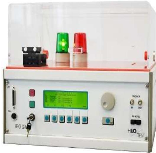
高压脉冲发生器 IPG 1201 是特别为测试元器件、绝缘体、空气和表面电弧间隙的介电强度而设计的。特别是可接触部位与有危险的工作部位之间的绝缘部分的抗浪涌能力，例如天线与电源终端的连接，请参阅 EN 60065。
